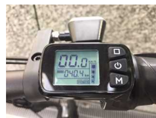
手元のスイッチ (原動機の電源が 入っている)
